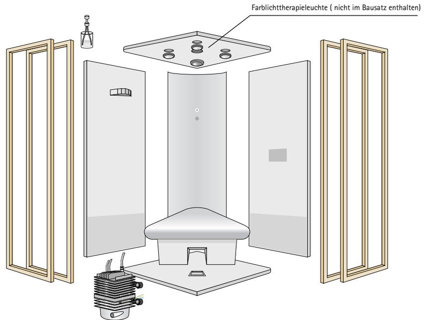
**Optional erhältlich:** Dampfaggregat mit Steuerung *(Umwandlung zur Dampfkabine mit Solezerstäubung)*, Farblichttherapieleuchte.
